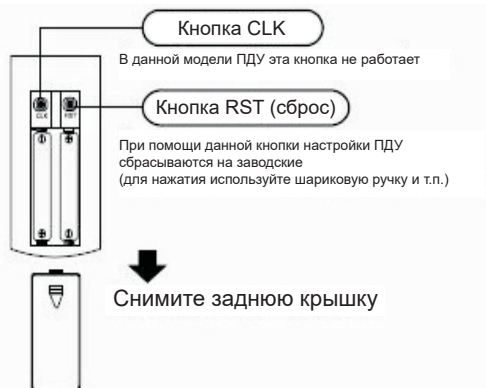
Рисунок 2 - порядок замены батареек в пульте управления
