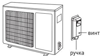
2. Снимите резьбовые заглушки штуцеров и совместите раструбы трубопроводов и конусы штуцеров подключения.
