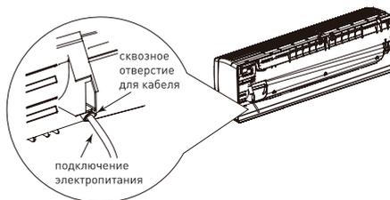
3. Открутите скобу крепления кабеля; подключите жилы кабеля питания к соответствующим клеммам на клеммнике внутреннего блока в соответствии с указаниями ниже; затяните винты, а затем закрепите кабель с помощью скобы крепления.
