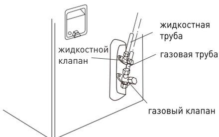
3. Предварительно затяните соединительную гайку рукой.
