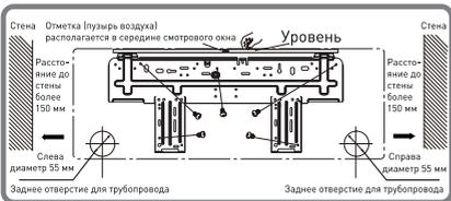
2. В зависимости от модели кондиционера выполните отверстие для трубопровода диаметром 55 мм в соответствии с выбранным местом для выходных трубопроводов. Чтобы обеспечить плавность слива следует выполнить отверстие под углом 5-10 ° вниз к наружной стороне стены.
