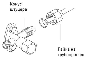
4. Затяните накидную соединительную гайку соответствующим моментом, используя динамометрический ключ, необходимый момент затяжки указан в таблице.
