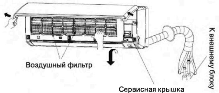
4. Пропустите провода межблочных соединений от наружного блока через отверстие в задней части корпуса внутреннего блока. Выведите их с лицевой стороны, предварительно открутив сервисную крышку.
